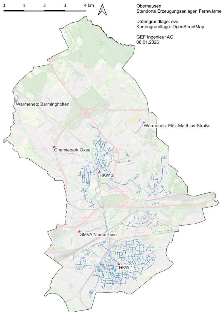
Abbildung 20: Bestehende Wärmeerzeugungsanlagen, die in ein Wärmenetz einspeisen
