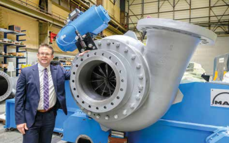
Der Everllence-Standortchef vor einer Turbomaschine für einen Energiespeicher.
