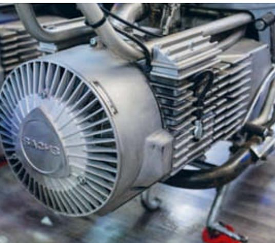
Ein Sachs-Wankelmotor mit dem charakteristischen Kühlluftgebläse. Die Motorräder nannte man deshalb etwas despektierlich „Staubsauger“.
