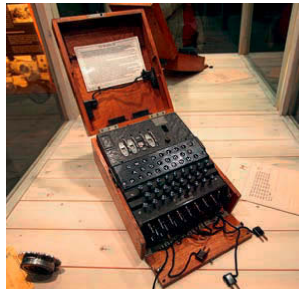
Die Enigma: Rotor-Chiffriermaschine der Deutschen Wehrmacht
