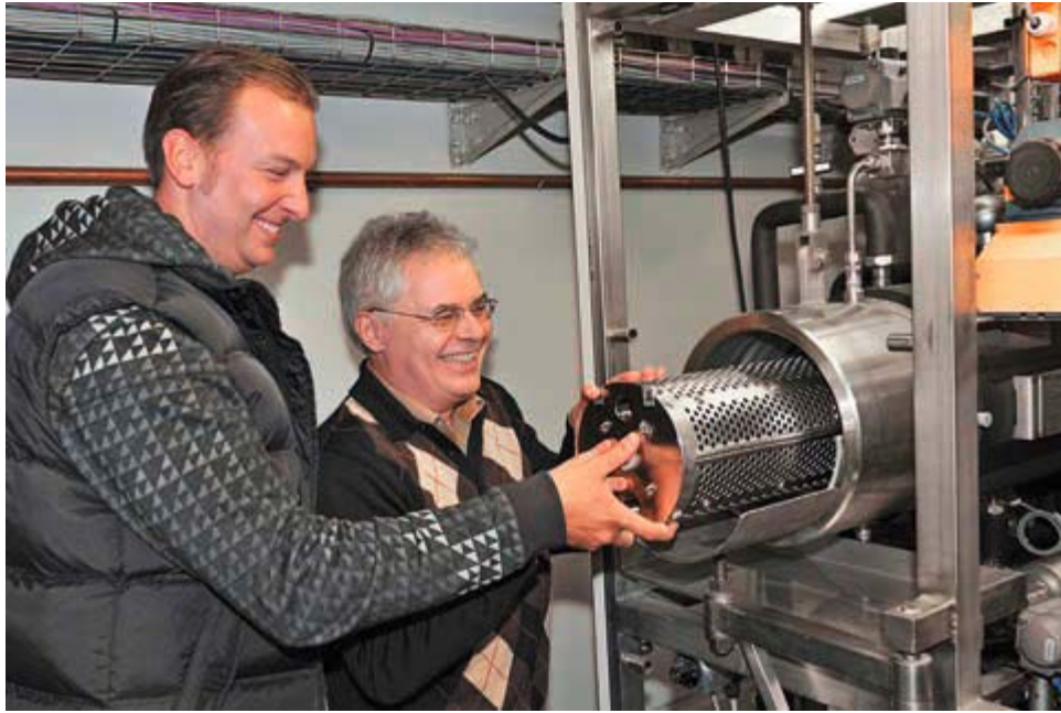
Institutsleiter Prof. Dr. Eckhard Weidner (r.) mit einem Mitarbeiter vor der Anlage, in der „noch“ in kleinem Maßstab Leder mit Hochdruck fast abwasserfrei gegerbt wird
