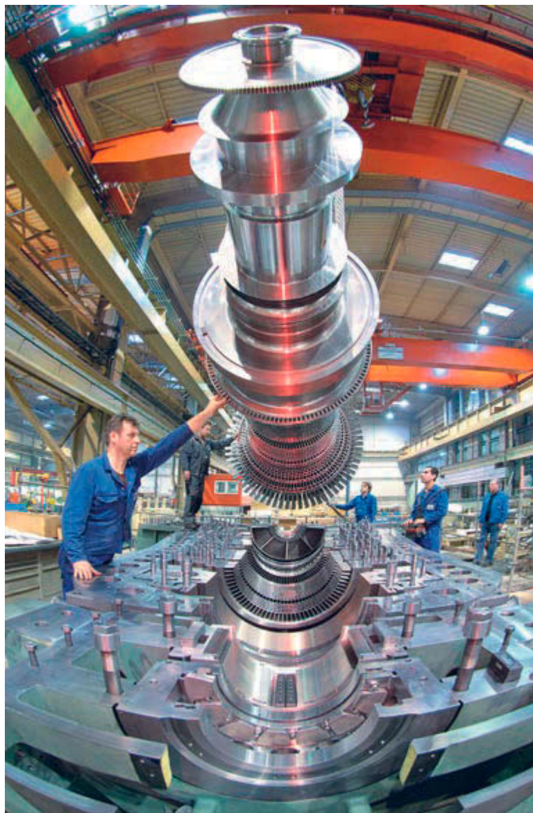
Läufer einer Dampfturbine der MAN Turbo AG, die als Generatormaschine zur Stromerzeugung in einem norddeutschen Stahlwerk eingesetzt wurde
