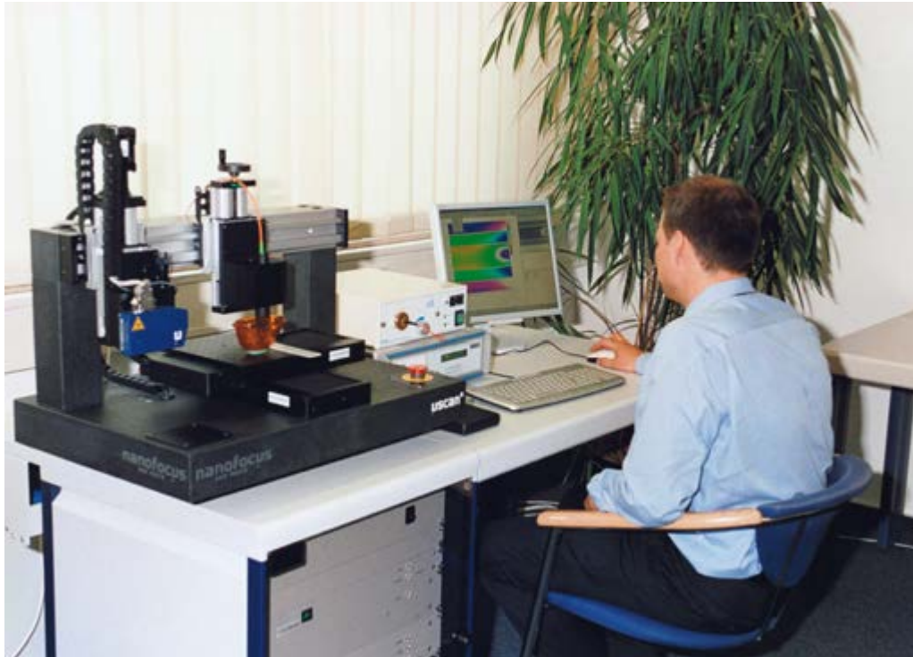
Mit dem 3D Mikroskop werden Oberflächen hochgenau vermessen
