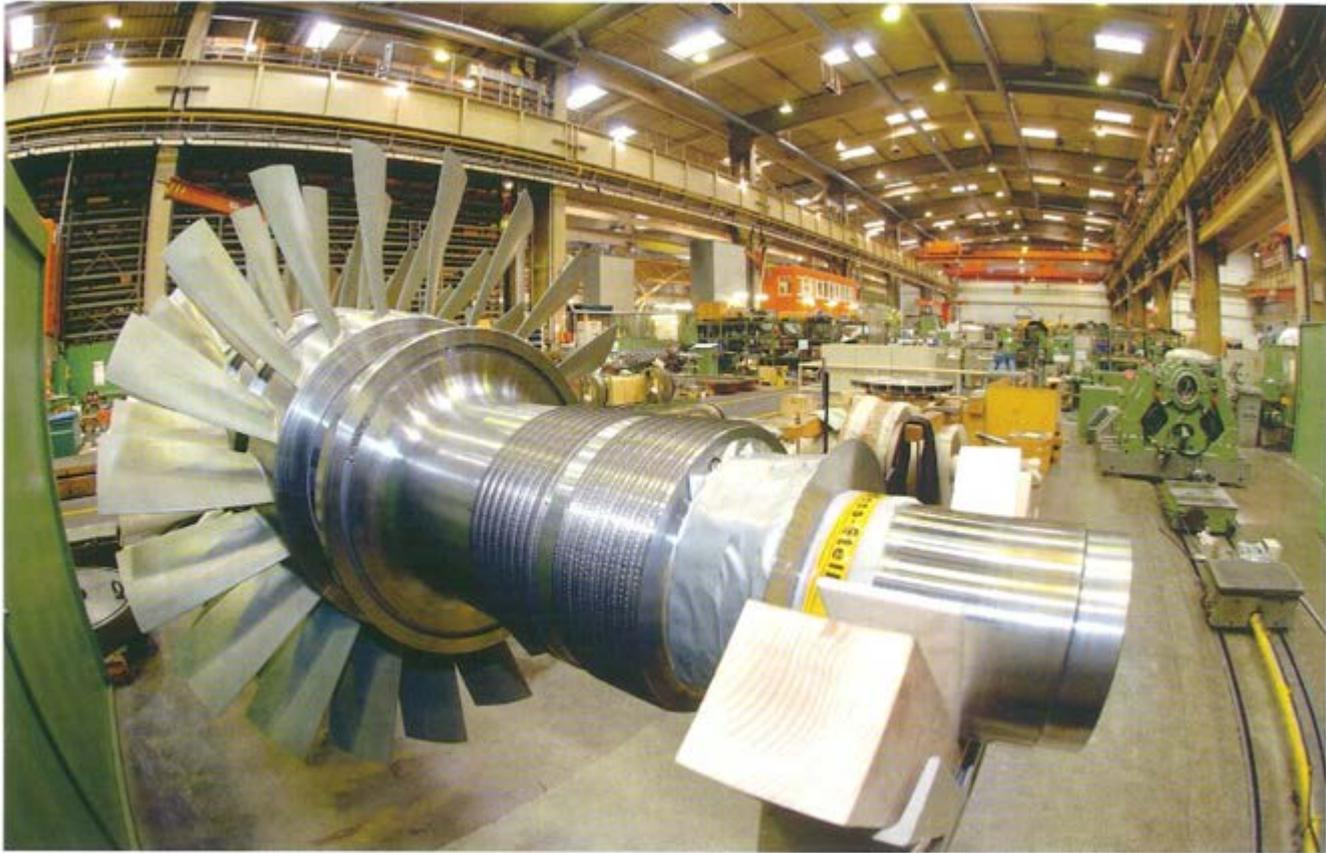
*Rotorfertigung mit Laufer eines Axialkompressors*
