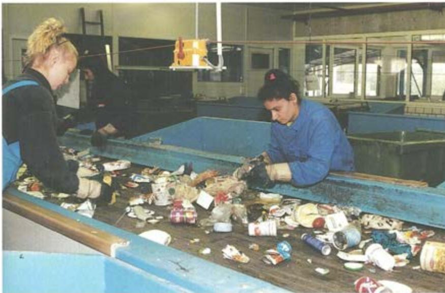
fen, werden hier dem Müllkreislauf entnommen. Besonders die wiederverwertbaren Stoffe des Dualen Systems, also der Inhalt der gelben Säcke und Tonnen, wird aussortiert. Zudem wird der angelieferte Sperr- und Gewerbemüll der Stadt von Stör- und Schadstoffen befreit, die den Verbrennungsprozeß der
