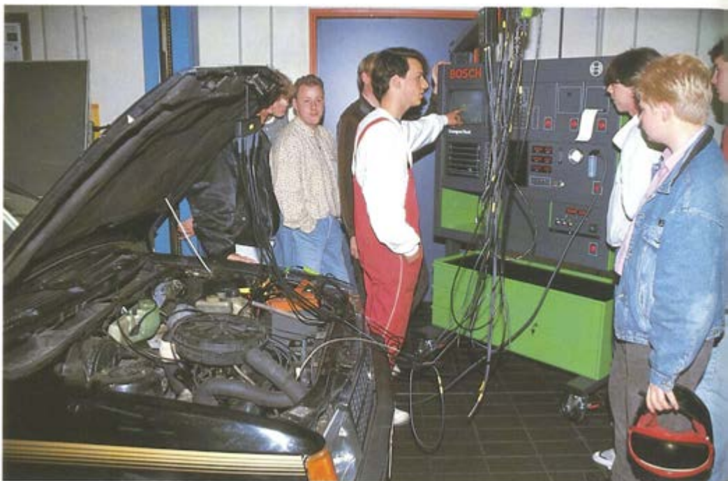
Werkstattgerechte Prüfung der Zündung.
