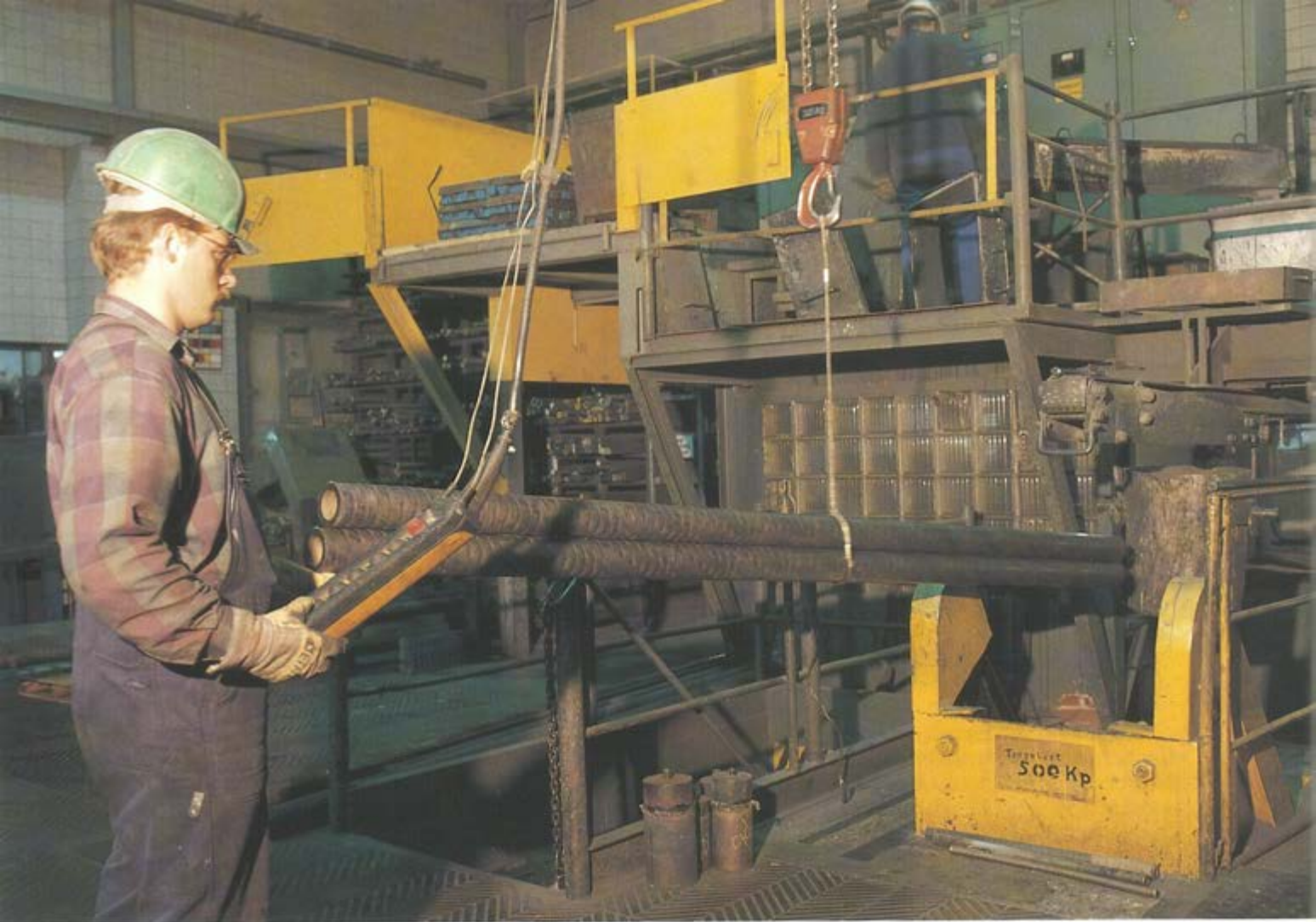
Stranggußanlage mit Entnahme von drei Meter langem Rohmaterial.
