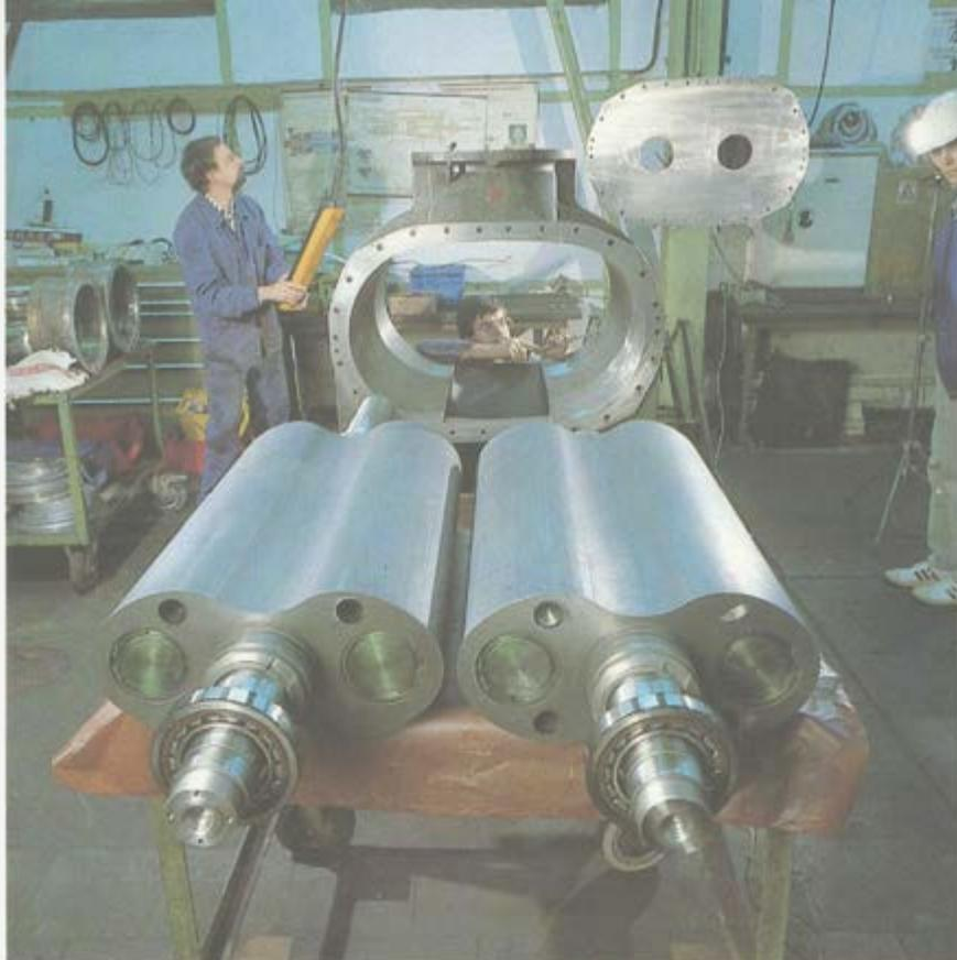
*Großreparatur in der Zentralwerkstatt; ein Gasverdichter wird zerlegt.*
