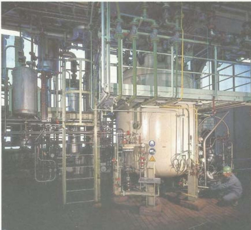
*Technikumsanlage zur Wiederaufarbeitung von Katalysatoren.*
