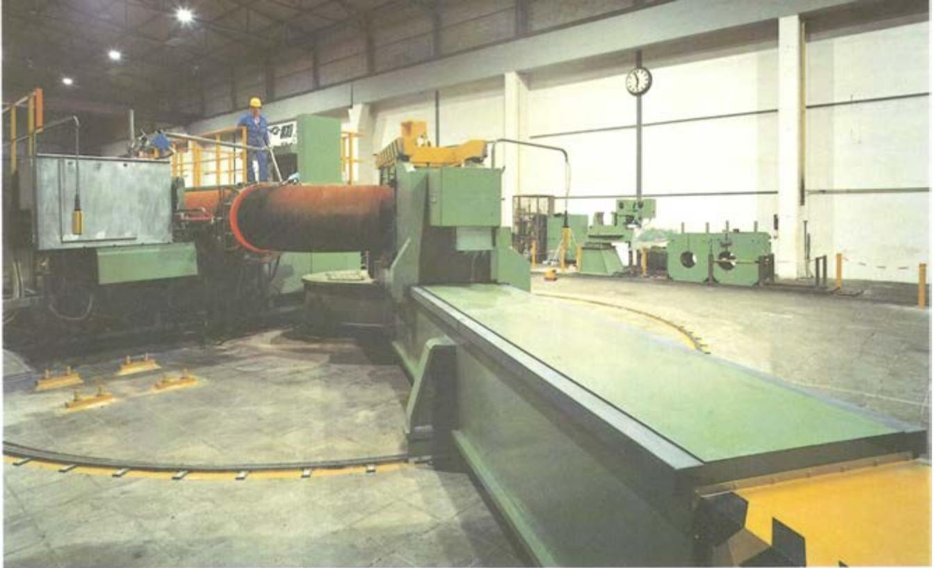
*Rohrbiegemaschine im Werk Friedrichsfeld*
