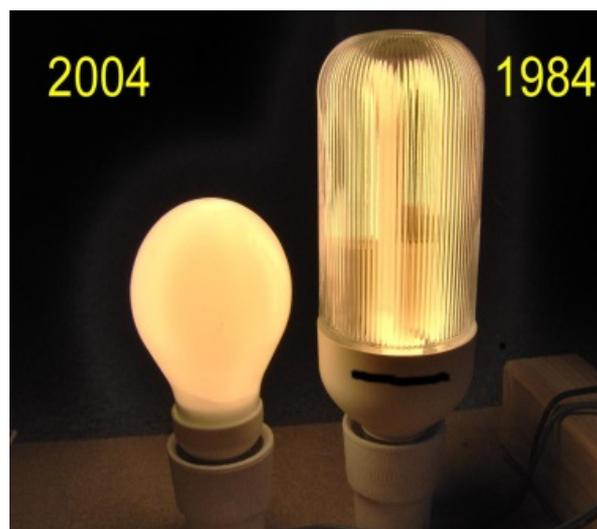
Kompaktleuchtstofflampe von 1984 mit konventionellem Vorschaltgerät und 2004 mit elektronischem Vorschaltgerät, Quelle: Wikimedia commons –Benutzer:Eule4404 / <https://www.wikiwand.com/de/Kompaktleuchtstofflampe>
